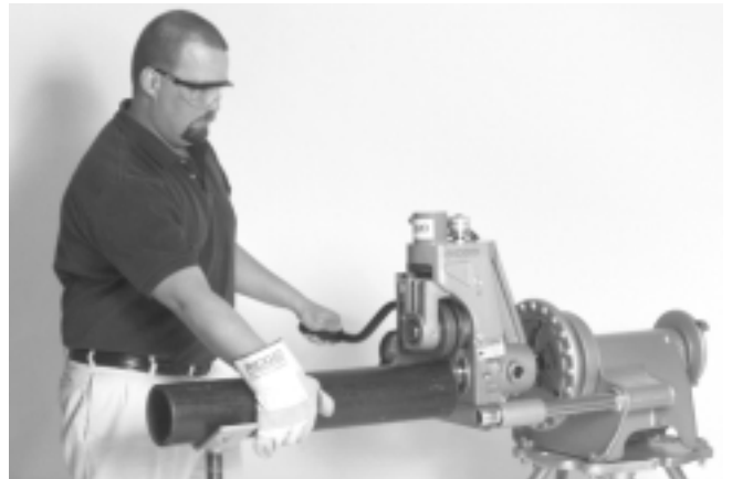
Figure 16 – Éloignement du tuyau lorsque le moteur d'entraînement tourne en marche arrière (REV)
