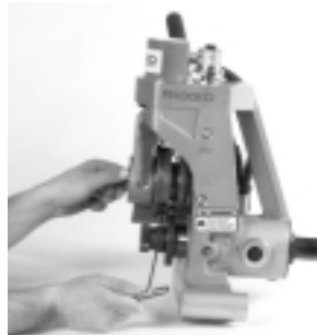
Figura 17 – Se afloja el tornillo de retención del rodillo ranurador
