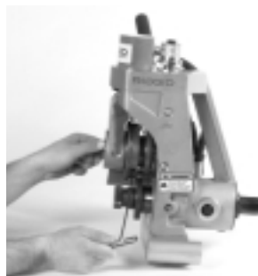
Figure 17 – Desserrage de la vis de blocage des galets de rainurage
