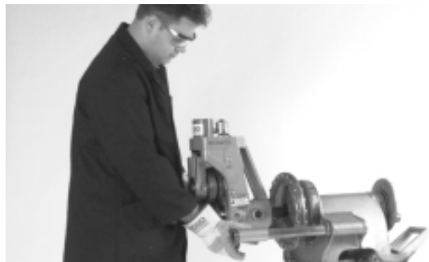
Figura 2 – Instalación del Accionamiento Propulsor No. 300
