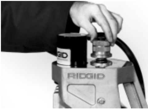
Figura 14 – Primer plano de la perilla de ajuste de la profundidad retrocedida. Queda un espacio entre la parte inferior de la perilla y la carcasa
