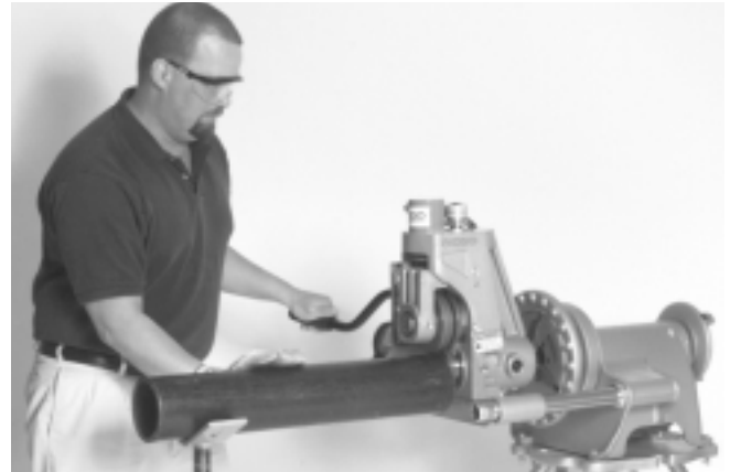
Figure 15 – Rapprochement du tuyau lorsque le moteur d'entraînement tourne en marche avant (FOR)
