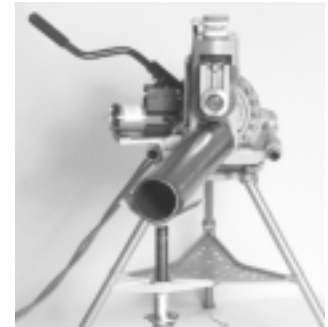
Figura 13 – Tubo desviado cuando la 918 marcha en reversa (REVERSE)
