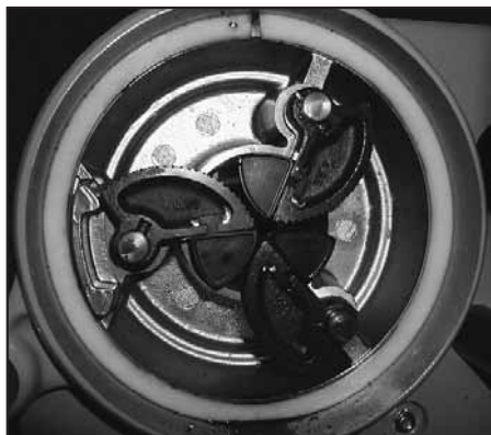
Fig. 4: Vorderes Spannfutter (19) Fig. 4: Front chuck (19) Fig. 4: Mandrin avant (19) Fig. 4: Mandrino anteriore (19) Fig. 4: Mandril de sujeción anterior (19) Fig. 4: Voorste spanklauw (19) Fig. 4: Främre spännchuck (19) Fig. 4: Fremre spennchuck (19) Fig. 4: Forreste patron (19) Kuva 4: Etuistukka (19) Fig. 4: Mordentes de aperto anteriores (19) Rys. 4: Przedni uchwyt zaciskowy (19) Obr. 4: Přední sklíčadlo (19) Obr. 4: Predné sklíčovadlo (19) 4. ábra: Első tokmány (19) Sl. 4: Prednji stezni uložak (19) Slika 4: Sprednja vpenjalna glava (19) Fig. 4: Mandrina anterioară (19) Фиг. 4: Передний зажимный патрон (19) Εικ. 4: Μπροστινός σφιγκτήρας (19) Resim 4: Ön sıkıştırma mandreni (19) Фиг. 4: Преден универсал (19) 4 pav.: Priekinis kumštelinis griebtuvas (19) Att. 4: Priekšējā spīles ietvere (19) Joonis 4: Eesmine pingutuspadrun (19)
